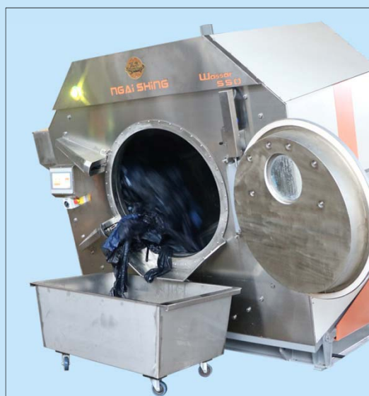
可傾斜卸料系統 Tilting system for garment unloading
